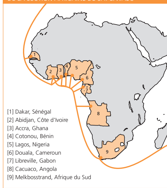
FIGURE 3 : POINTS D'ATERRISSAGE DE LA SECTION AFRICAINE DE SAT-3/WASC
